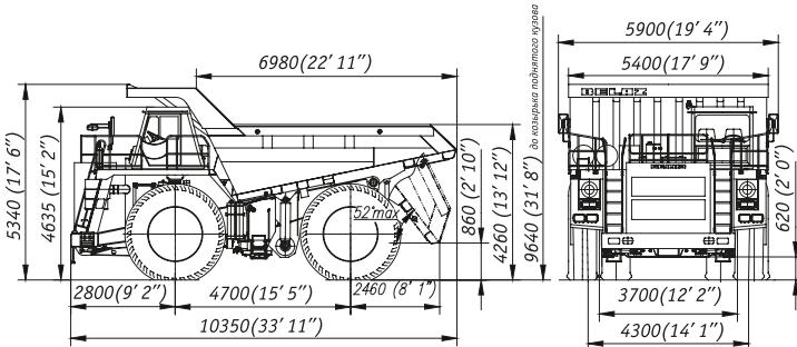
Габаритные размеры указаны для базовой комплектации машин.
