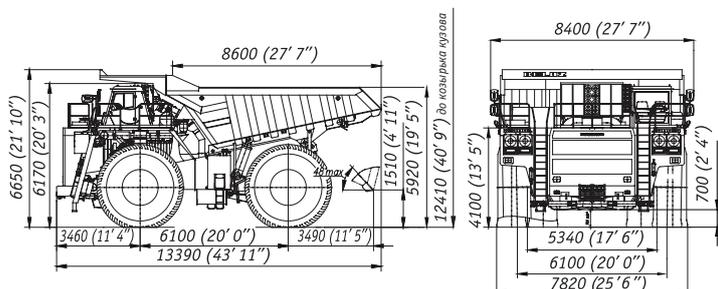
Габаритные размеры указаны для базовой комплектации машин. Ввиду постоянного совершенствования техники представленные технические характеристики могут быть изменены без предварительного уведомления.
