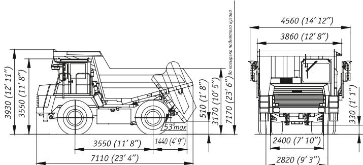
Габаритные размеры указаны для базовой комплектации машин.
