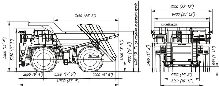
Габаритные размеры указаны для базовой комплектации машин.
