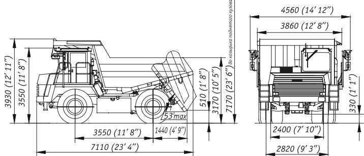
Габаритные размеры указаны для базовой комплектации машин.
