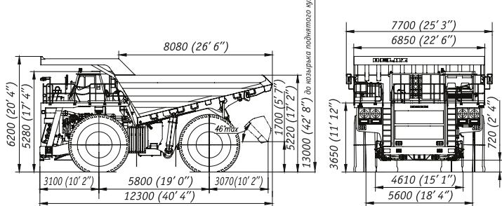
Габаритные размеры указаны для базовой комплектации машины.
